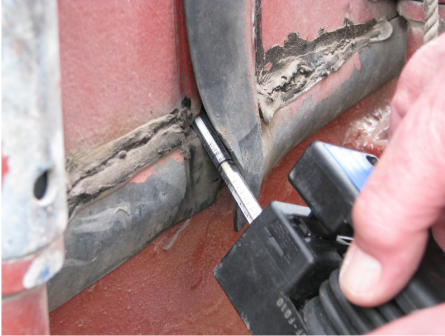
Abbildung 4: Messung auf Methylbromid
