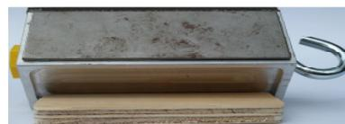
den Reibklotz mit der Aussparung über den mobilen Materialträger stülpen (Verbindung erfolgt über Formschluss)
