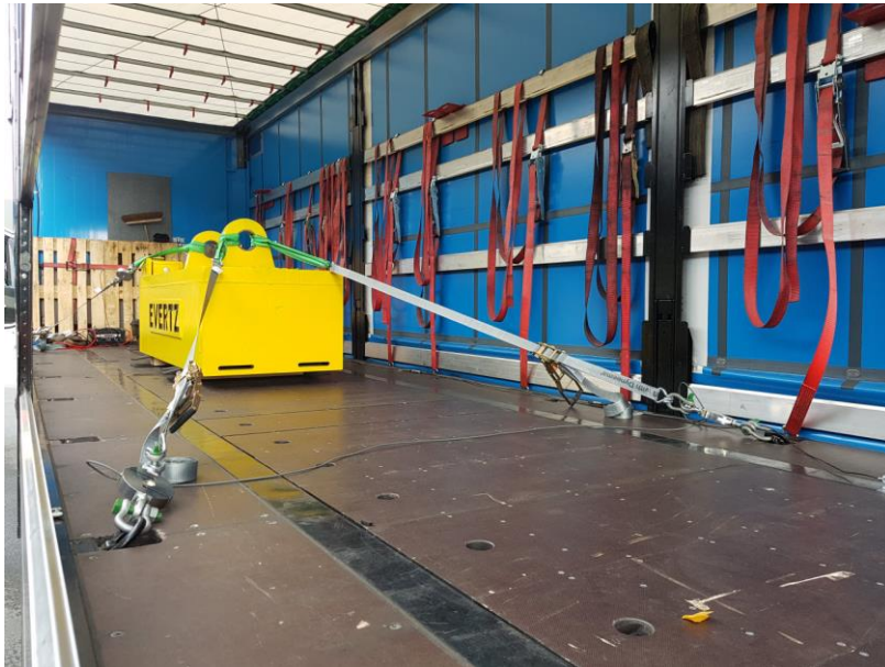
Abbildung 2 SICHERUNG DER LADUNG, MASSE 6000 KG, thyssenkrupp Steel Europe
