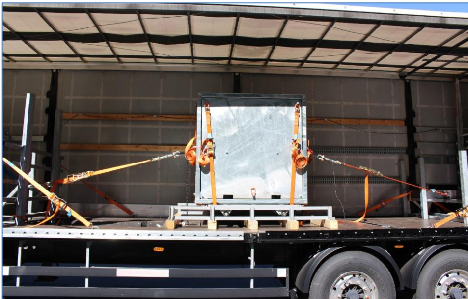
Abbildung 1 PROBELADUNG UND VERSUCHSAUFBAU | REIBUNGSFREIER ZUSTAND, F&T Selm
