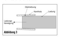
Hier wird die Bewegungsenergie durch Reibungsarbeit an den Seitenflächen gewandelt; statt mit Kräften wird mit einem energetischen Wandlungsprozess die maximale Rückhaltekraft gemindert. Energiewandlung zur Verringerung der Maximalkräfte bedeutet aus theoretischer Sicht, dass die maximale Kraftamplitude niedriger wird, dafür aber länger dauert (Abb. 4). Die Flächen unter der Kurve stellen aus
